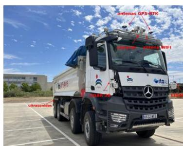
Figura 1: Conjunto de sensores sobre el camión
