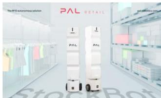
En los centros de distribución y almacenes de picking, donde la velocidad y la precisión son esenciales, StockBot, desarrollado por PAL Robotics, se presenta como una solución autónoma con tecnología RFID para el control de inventario. El robot permite descubrir el inventario real, reducir los *phantom items* y garantizar una trazabilidad total. Más que automatizar el conteo, StockBot ofrece una nueva forma de ver y entender el stock disponible: qué hay realmente, dónde está y qué falta.
