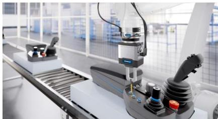
El sensor de fuerza-par FTS de 6 ejes de SCHUNK funciona con precisión, alta resolución y flexibilidad. Estas características lo convierten en una solución de final de brazo que garantiza la máxima eficacia y seguridad de los procesos de automatización. Se utiliza en una amplia gama de aplicaciones, como el control de calidad, el control de procesos y los procesos de rectificado o montaje.
