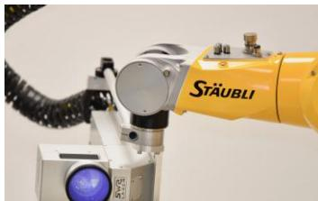
La fiabilidad, la sostenibilidad y la calidad desempeñan un papel decisivo al soldar celdas de ion-litio en paquetes de baterías listos para la instalación, ya que los cortocircuitos u otros daños pueden tener consecuencias graves. La soldadura láser remota mediante robots garantiza el más alto nivel de seguridad y eficiencia.
